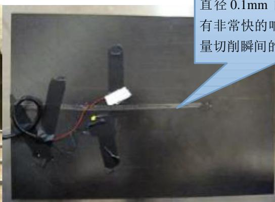
直径 0.1mm 的细丝热电偶具有非常快的响应速度,可以测量切削瞬间的温度
